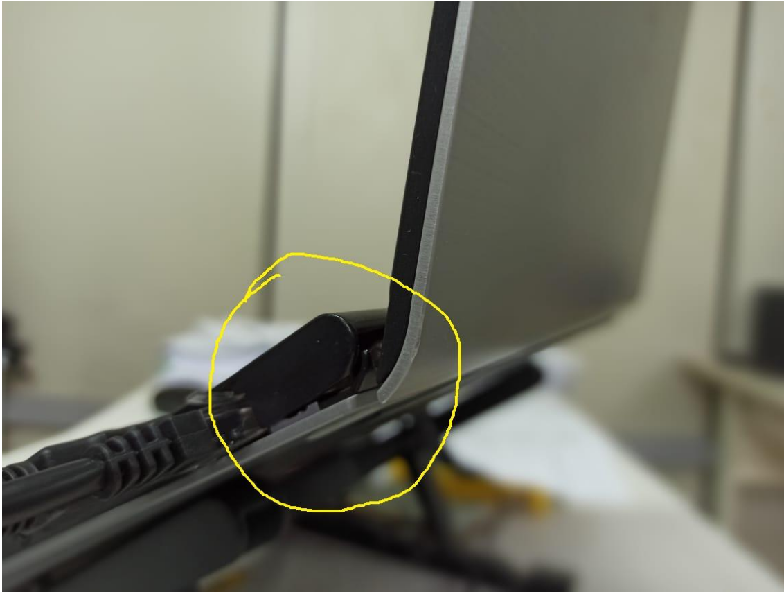
Figura 1 – Imagem em detalhe da avaria na base de sustentação da tela
